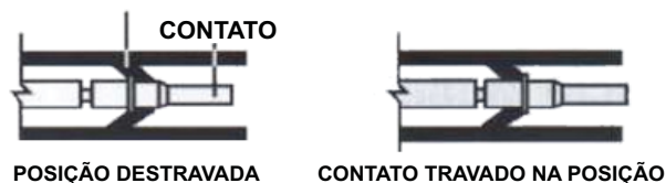
Figura 7-17. Travamento dos contatos HD/HDP na posição
